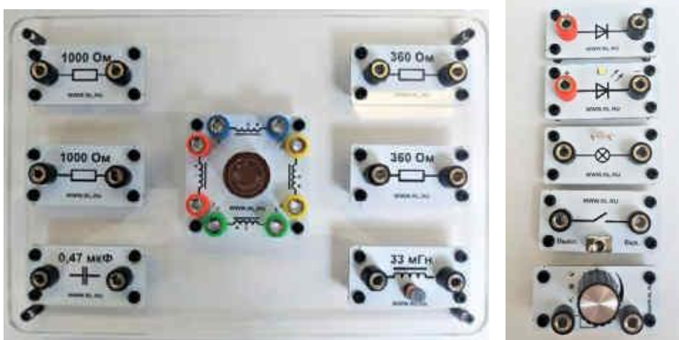
Дополнительные элементы электрических цепей
